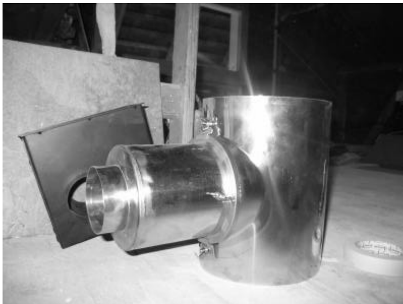
Einzelteile zum Einbauen des Feinstaub-Partikelabscheiders im Ofenrohr und Steuerungskasten.
