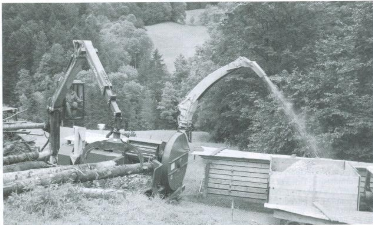
Jede Sekunde wächst im Emmental Holz nach. Bei der Pflege von ihrem Wald und ihrer Landschaft nutzen es die Bauern. Mit dem modernen Hacker werden Holzschnitzel hergestellt für die automatische Schnitzelheizung – «Oil of Emmental».
